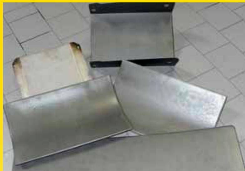
Die Härtebeschichtung der Stahlteile erfolgt bei 1450 °C.
