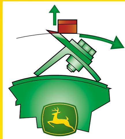
Beim John Deere Schleifsystem mit rückwärtslaufender Messertrommel trifft der Schleifstein zuerst auf den Messerrücken auf und wird dann über die ganze Messerfläche gezogen. Hierdurch entsteht eine schmale, scharfe Schneidkante. Zugleich wird die Rückwärtsbewegung der Messertrommel zur genauen Einstellung des Abstands zwischen Gegenschneide und Messerkante genutzt.
