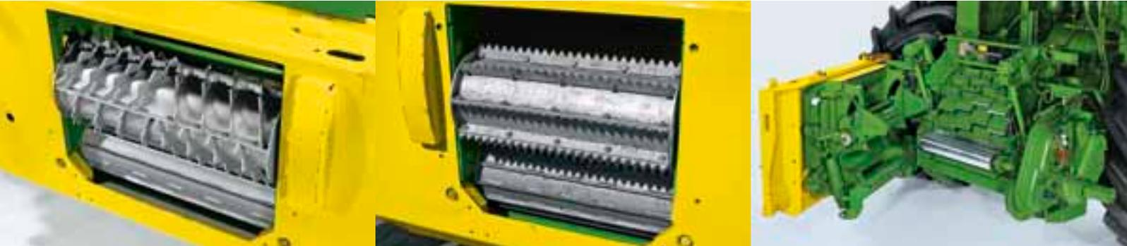
Für unterschiedliches Erntegut sind verschiedene Vorpressewalzen erhältlich, unter anderem spiralförmigen gezahnten oder mit austauschbaren gezackten bzw. glatten Leisten für die Ernte unter abrasiven Bedingungen. Das Vorpresseaggregat lässt sich zur leichten Wartung und Reinigung weit öffnen.
