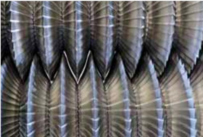
In umfassenden Feldversuchen in Neuseeland stellte der KernelStar Scheibenprozessor – selbst bei einer Schnittlänge von 22 mm im Mais – seine Effizienz hinreichend unter Beweis: Die perfekt zerschlagenen Körner sorgen für einen besseren enzymatischen Aufschluss, erleichtern somit die Verdauung und steigern die Milchproduktion. Darüber hinaus gibt Ihnen der ebenfalls für die Ganzpflanzenernte geeignete KernelStar höchste Flexibilität.
