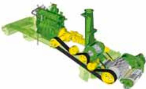
**Effizienter Antrieb** – Ein Kegelgetriebe sorgt für die mechanische Kraftübertragung der Motorleistung auf alle Gutfluss-Komponenten bis zum Vorsatz. Dieser einzigartige Direktantrieb mit automatisch gespanntem Kevlar-Riemen ist wartungsfrei. Der automatisch spannde Riemen überträgt seine Last nicht direkt auf die Motorkurbelwellen, wodurch der Motor weniger beansprucht wird und somit länger hält.
