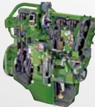
Der Abgasstufe III B konforme John Deere PowerTech Plus™ Motor der Feldhäcksler-Serie 7080 verfügt über einen Turbolader mit variabler Geometrie. Durch das hohe, stabile Drehmoment im niedrigen Drehzahlbereich reagieren die Feldhäcksler weniger empfindlich auf plötzliche Veränderungen der Feld- und Erntebedingungen (z.B. schwankende Bestandsdichte).
