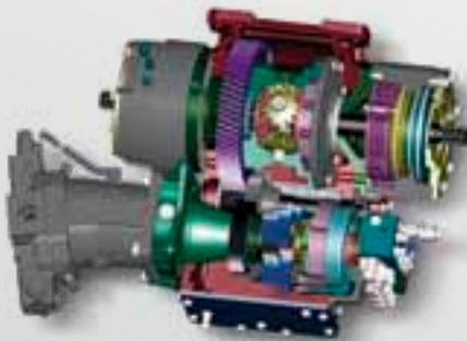
Das vollautomatische ProDrive Getriebe von John Deere passt die Fahrgeschwindigkeit des Feldhäckslers im Feld und auf der Straße selbstständig den Arbeitsbedingungen an, ohne die Motordrehzahl zu erhöhen.
