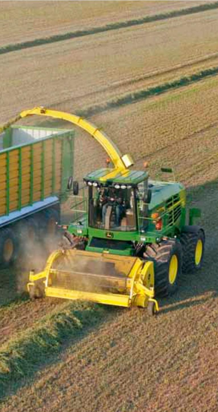
Die Einzugschnecke ist mit Einzugsfingern bzw. -paddeln erhältlich. Bei der Fingerversion transportieren Multifinger das Erntegut praktisch bis zu den Vorpresswalzen und ermöglichen so den gleichmäßigen Gutfluss von leichten, späten Gräsern. Bei der wartungsarmen Paddelversion können die Paddel in unterschiedlichen Fruchtarten für den jeweils optimalen Gutfluss eingestellt werden.
