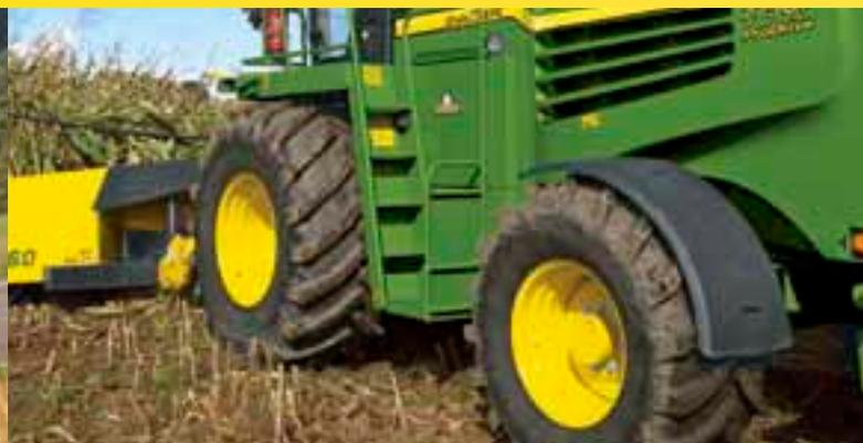
Unterschiedliche Geschwindigkeiten an den Achsen sorgen für bodenschonendes Wenden am Vorgewende.
